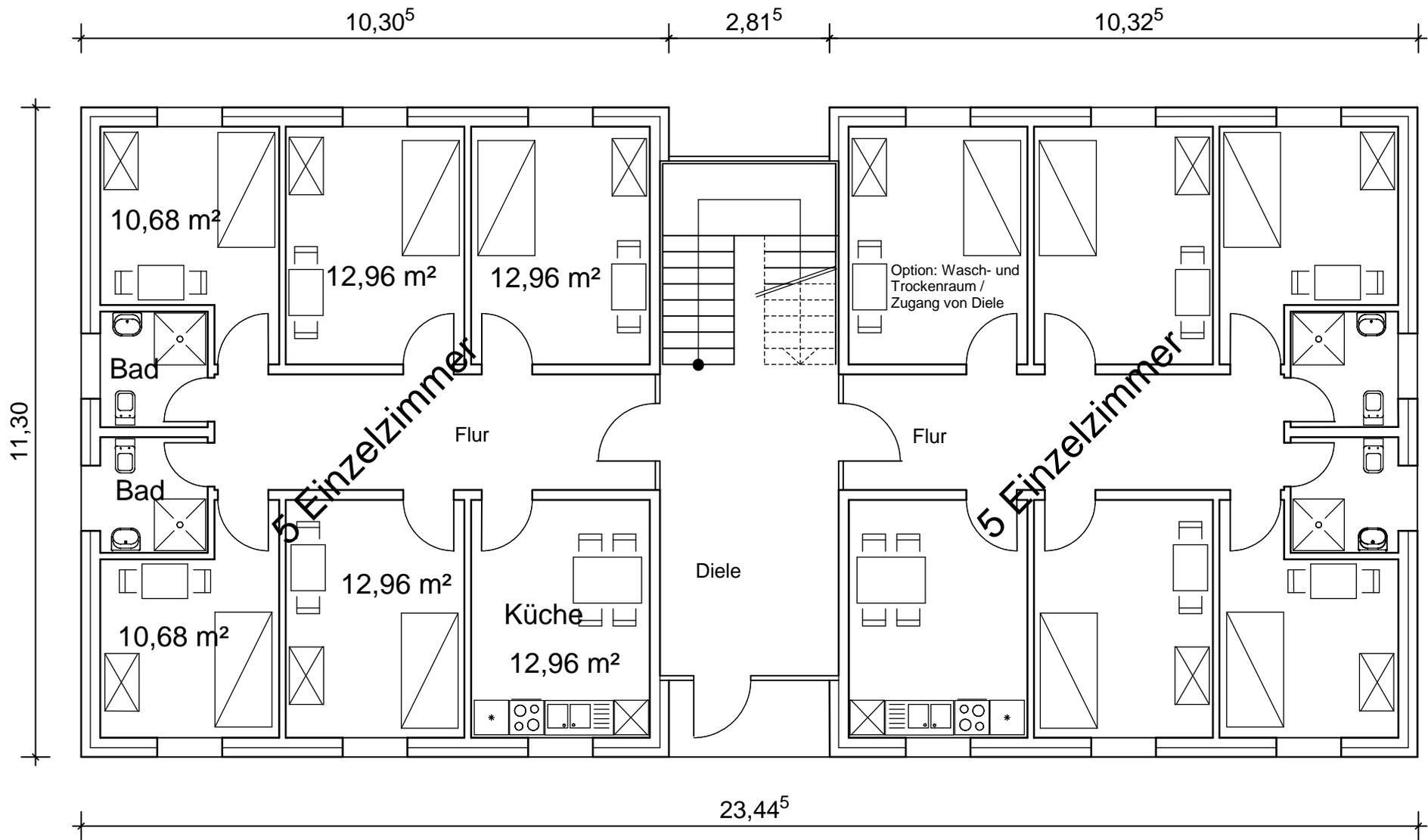
Neubau Obdächer / EG / M.: 1:100 / Grundfläche: 264,93 m<sup>2</sup> / Umbauter Raum: rd. 800 m<sup>3</sup> / Datum: 04.03.2010 / Gu **Variante 6**
