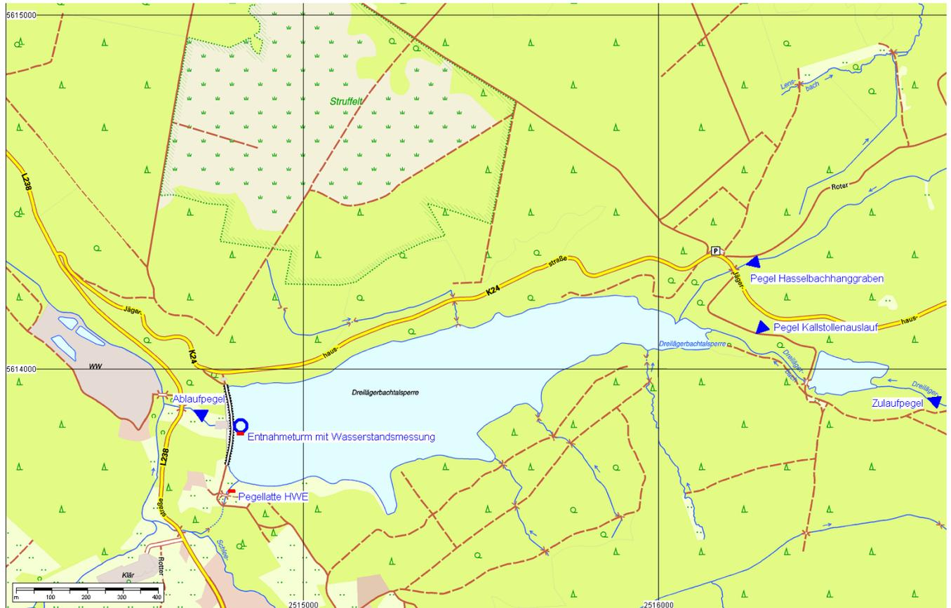
Abbildung: Anordnung der Wasserstands- sowie Zu- und Abflussmessungen
