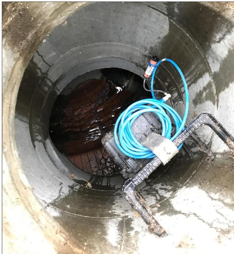
**Abbildung 6: Durchflussmessung im Regenwasserkanal**
