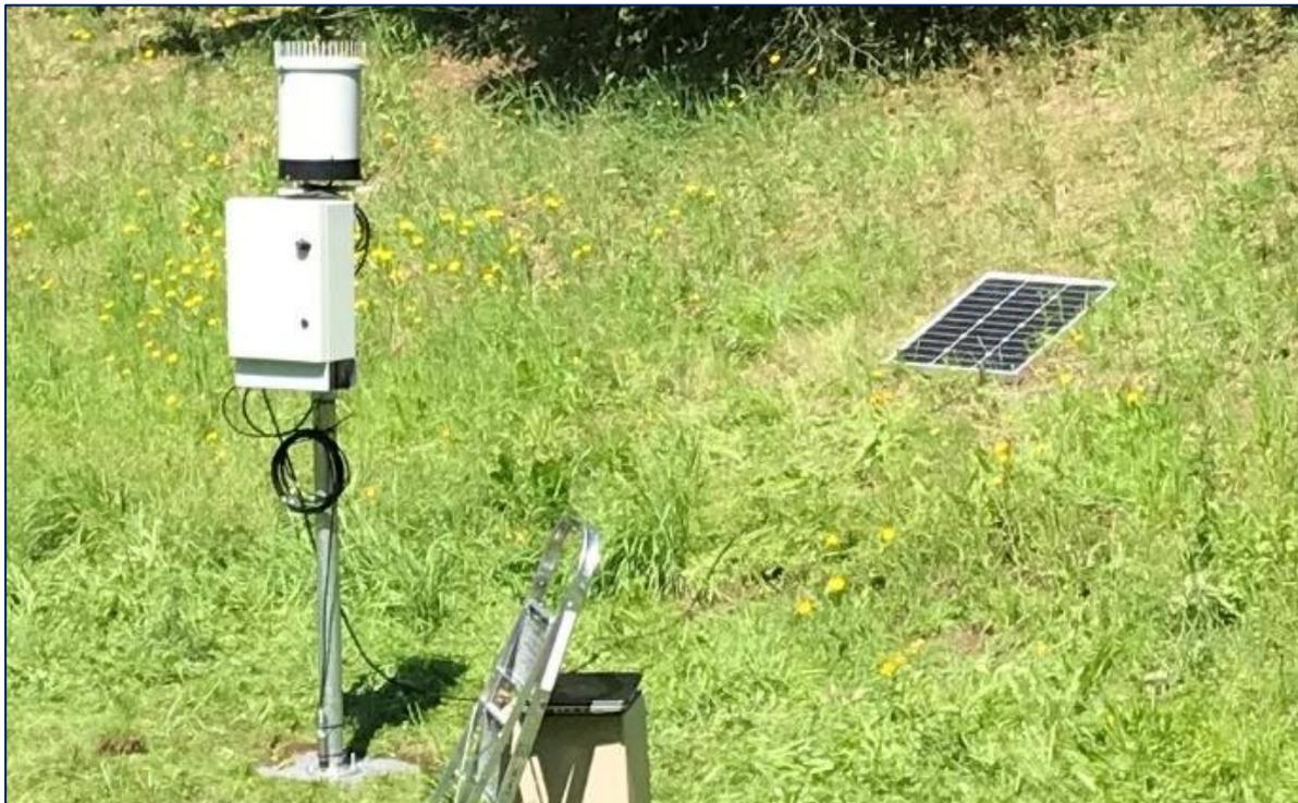
**Abbildung 2: Messtation mit Solarpanel**
