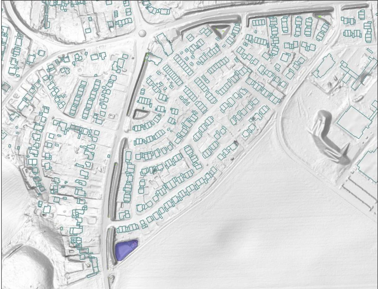
Abbildung 2-4: 2D-hydraulisches Modell mit Gebäuden (Polygone) und VB Am Schlosswald (blaue Fläche)
